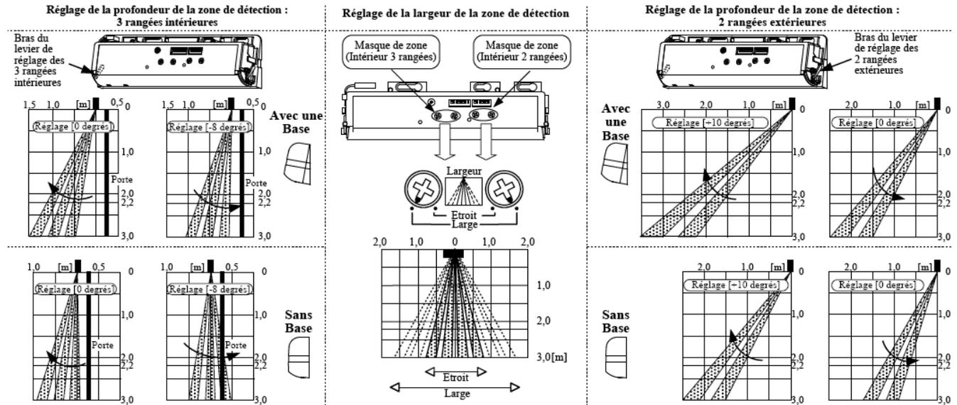
**ATTENTION** Les zones de détection illustrées ci-dessus représentent la position réelle des rayons infrarouges. La zone de détection réelle observée dépendra de l'environnement de l'installation du capteur, de l'objet détecté et des réglages du capteur. Assurez-vous que la zone de détection est conforme à EN16005
